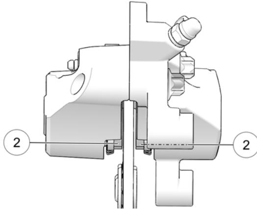
Controllando lo spessore del materiale di attrito della pastiglia del freno, verificare anche che su ciascuna pinza del freno non vi siano tracce di umidità o macchie derivanti da perdite o liquido dei freni essiccato. Se l'ispezione rivela tracce di perdita di liquido, non utilizzare il veicolo. Contattare il proprio concessionario per l'assistenza.
