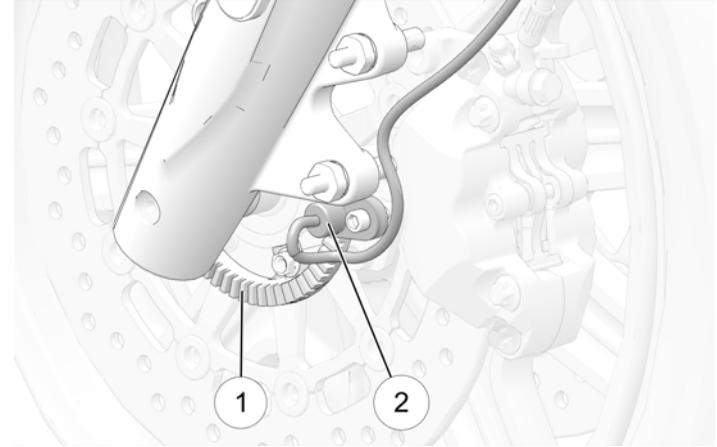
2. Controllare che non vi siano detriti attaccati all'estremità dei sensori di velocità delle ruote ②. Se si osserva contaminazione, o se non si riesce a controllare a vista, far scorrere un panno sottile lungo la superficie del sensore tra il sensore e la ruota fonica per rimuovere eventuali detriti.
