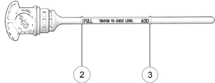
7. Reinstallare saldamente l'astina.
