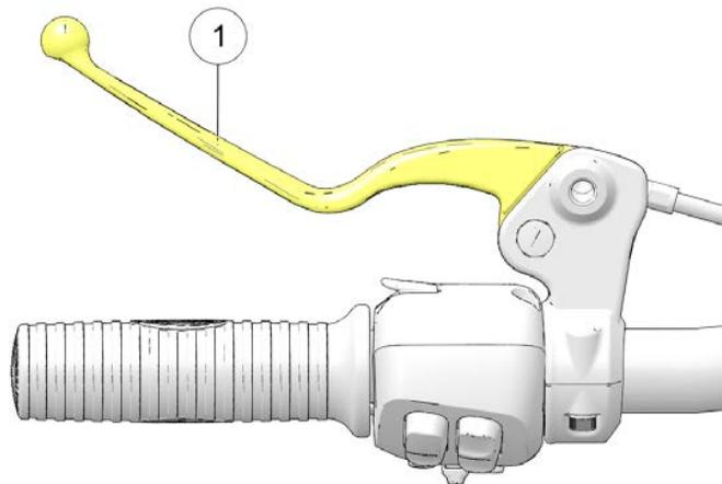
2. Il gioco (distanza) è l'escursione della leva dalla posizione di riposo al punto in cui il cavo fa resistenza. Il gioco della leva della frizione deve essere di 0,5-1,5 mm. Misurare la distanza tra la leva della frizione e il punto di attacco della leva. Regolare il gioco della
