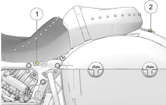
4. Nei modelli dotati di sella del passeggero, rimuovere il bullone della staffa posteriore ②, la rondella e l'anello di tenuta in nylon.
