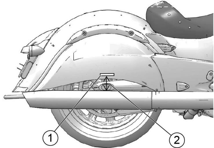
Ispezionare periodicamente il precarico dell'ammortizzatore posteriore. Per una guida il più confortevole possibile e una corretta altezza dal suolo, regolare il precarico se l'altezza di marcia non rientra nelle specifiche.
