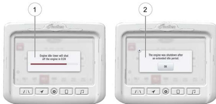
Per motociclette dotate di Ride Command, una notifica mostra un timer di conto alla rovescia per avvertire che il motore si sta per spegnere ①. Appena dopo che scade il tempo e il motore si spegne, viene visualizzata un'ulteriore notifica ②. Quando si spegne il motore, è possibile riavviarlo premendo l'interruttore di avviamento.
