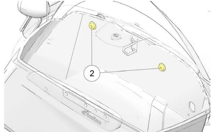
6. Inclinare la borsa da sella allontanandola dal telaio del veicolo per rimuoverla.
