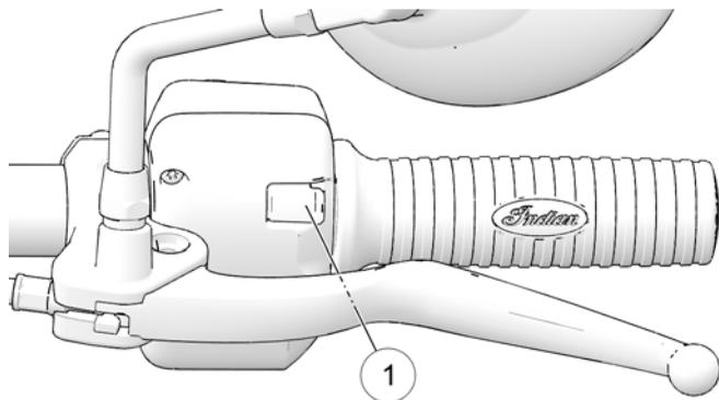
L'interruttore di accensione deve essere in posizione **ACCESO** perché i commutatori possano funzionare. Usare il comando sul lato destro per navigare attraverso i menù o accettare le finestre di dialogo sul display Ride Command. Usare l'interruttore sul lato sinistro per uscire dai menù, rifiutare le finestre di dialogo, riagganciare il telefono e spostarsi tra le schermate del display.
