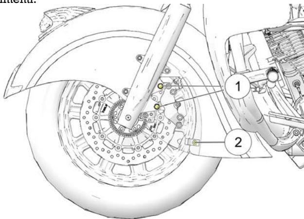
2. Posizionare uno specchietto sul lato anteriore della pinza del freno per osservare il materiale di attrito.
