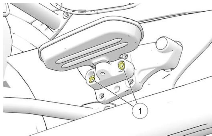
Per regolare l'altezza, rimuovere entrambe le viti di fissaggio. Spostare il gruppo della pedana sul foro della posizione successiva, quindi reinstallare i dispositivi di fissaggio, regolare l'inclinazione e stringere i dispositivi di fissaggio.
