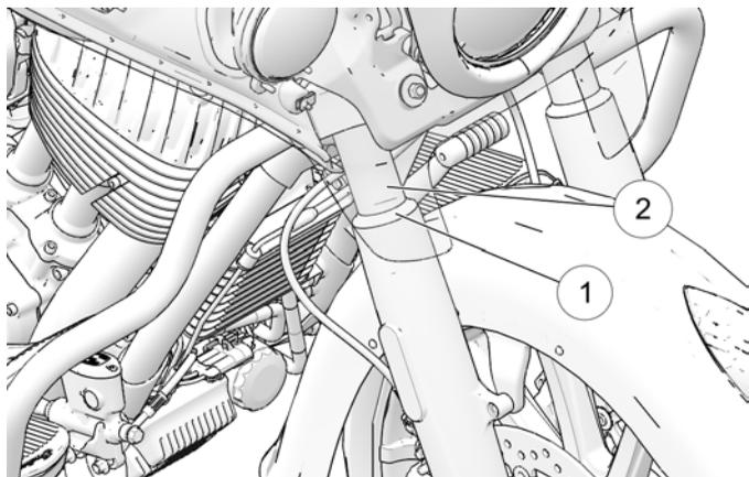
2. Pulire i tubi della forcella per rimuovere insetti, catrame o depositi che possono causare l'usura della tenuta o perdite. Verificare che le superfici esterne dei tubi interni delle forcelle non presentino graffi o danni causati da corpi estranei.
