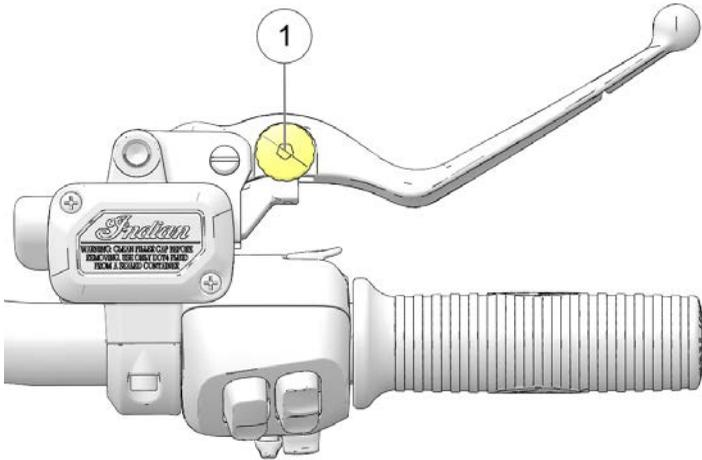
1. *Spingere delicatamente e tenere* la leva allontanandola della manopola. La rotella di regolazione ① si trova sulla parte superiore della leva.
