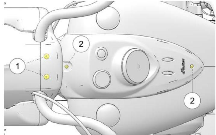
3. Rimuovere due dispositivi di fissaggio ② che fissano il rivestimento della console al serbatoio del carburante e sollevare la console all'indietro, quindi posarla sul serbatoio dopo averlo protetto.
