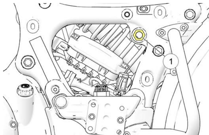
3. Stabilire la pressione dell'aria raccomandata per l'ammortizzatore posteriore. Fare riferimento all'etichetta posta sulla parte interna del rivestimento laterale sinistro.
