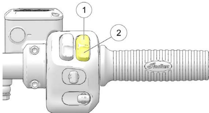
Premere la parte superiore dell'interruttore (STOP) ① per interrompere i circuiti e arrestare il motore. Il motore non deve essere avviato o in funzionamento se l'interruttore è nella posizione di ARRESTO.
