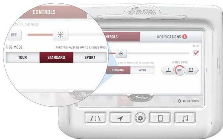
È possibile scegliere fra tre modalità di guida, Tour, Standard o Sport, per personalizzare il proprio stile di guida. La mappatura dell'acceleratore per ciascuna modalità di guida è stata ideata per una specifica applicazione, con il risultato di racchiudere tre personalità distinte in un'unica motocicletta.
