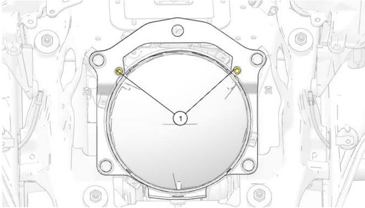
1. Sui modelli dotati di carenatura, rimuovere prima le due viti della cornice del faro (se in dotazione). Spingere con cautela verso il basso dal bordo superiore della cornice del faro anteriore per sganciare i dispositivi di blocco, quindi staccare la cornice dalla carenatura.
