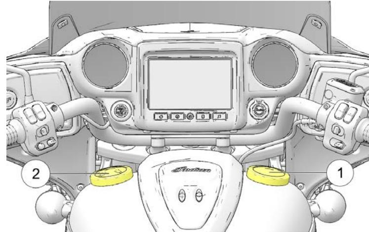
Girare il tappo del serbatoio del carburante in senso antiorario per rimuoverlo. Se il tappo del serbatoio è dotato di un fissaggio, collocare il tappo delicatamente sul serbatoio, appoggiato sulla gomma antiurto. Vedere pagina 90 per istruzioni sul rifornimento di carburante. Per serrare il tappo, girarlo in senso orario finché la guarnizione non aderisce bene al serbatoio; quindi continuare finché il tappo non scatta diverse volte.
