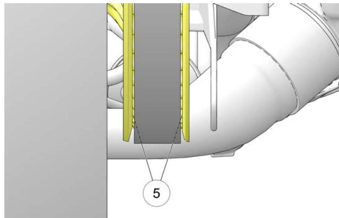
3. Se necessario, allentare il dado dell'asse e il dispositivo di regolazione LATO SINISTRO finché la cinghia non si stacca dalla flangia destra e inizia ad allinearsi al centro della flangia portacorona condotta, durante la rotazione in avanti della ruota.
