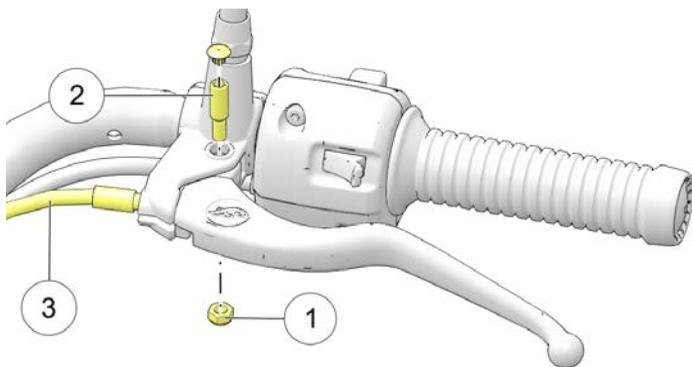
2. Rimuovere eventuali residui di grasso e sporcizia da leva e alloggiamento. Lubrificare la leva della frizione e la vite dello snodo con grasso per montaggio al bisolfuro di molibdeno o grasso multiuso.
