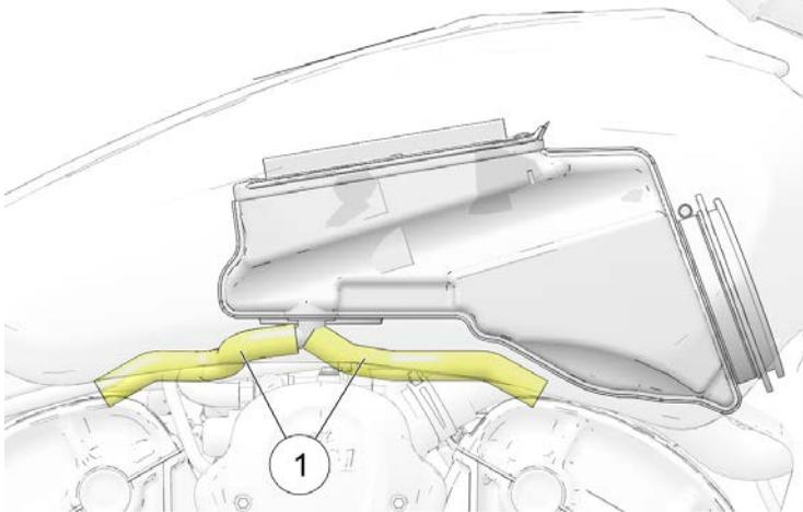
Ispezionare i tubi flessibili di sfiato del basamento ① ogni volta che si rimuove il serbatoio del carburante per eseguire la manutenzione del filtro dell'aria o un altro genere di intervento. Controllare i tubi per tutta la lunghezza e alle estremità. Accertarsi che i tubi flessibili non siano ostruiti, attorcigliati, fessurati o altrimenti danneggiati. Sostituire i tubi usurati o danneggiati.
