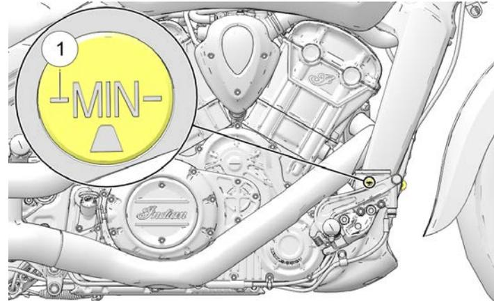
3. Il liquido deve essere chiaro. Sostituire il liquido se opaco o contaminato.
