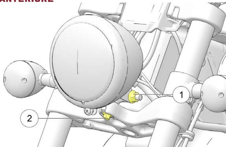
1. Per regolare verticalmente il faro anteriore allentare il dispositivo di fissaggio della sede ① e inclinare la sede in alto o in basso. Serrare il dispositivo di fissaggio.
