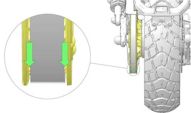
2. Far girare la ruota **IN AVANTI** e verificare che i denti della corona dentata siano ancora visibili su entrambi i lati della cinghia di trasmissione.
