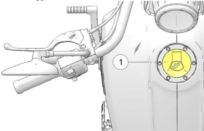
2. Inserire l'erogatore del carburante nel collo del bocchettone del serbatoio del carburante.
