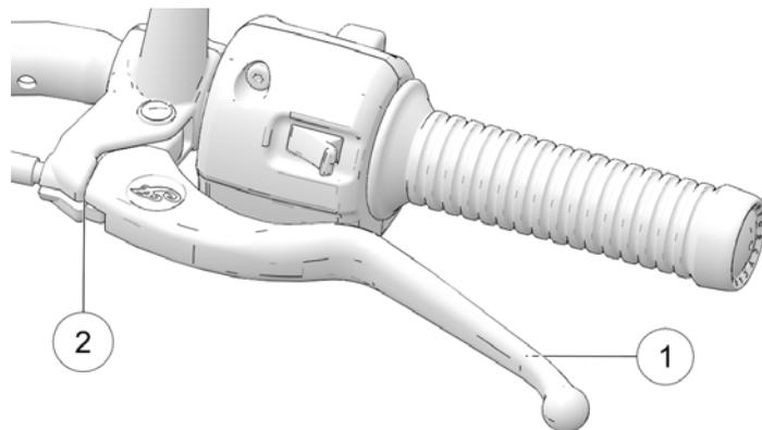
2. Il gioco (distanza) è l'escursione della leva dalla posizione di riposo al punto in cui il cavo fa resistenza. Il gioco della leva della frizione deve essere di 0,5-1,5 mm. Misurare la distanza tra leva della frizione e sede della leva ②. Vedere pagina 104. Regolare il gioco della leva della frizione, se necessario.
