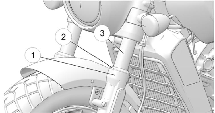
2. Pulire i tubi della forcella per rimuovere insetti, catrame o depositi che possono causare l'usura della tenuta o perdite. Verificare che le superfici esterne dei tubi interni delle forcelle non presentino graffi o danni causati da corpi estranei.
