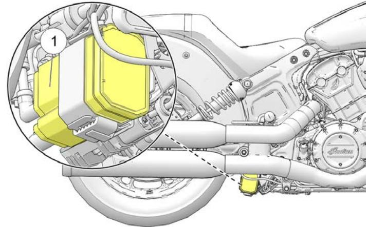
3. Ispezionare i collegamenti del canister del sistema di controllo delle emissioni di vapori per accertarsi che siano saldi.
