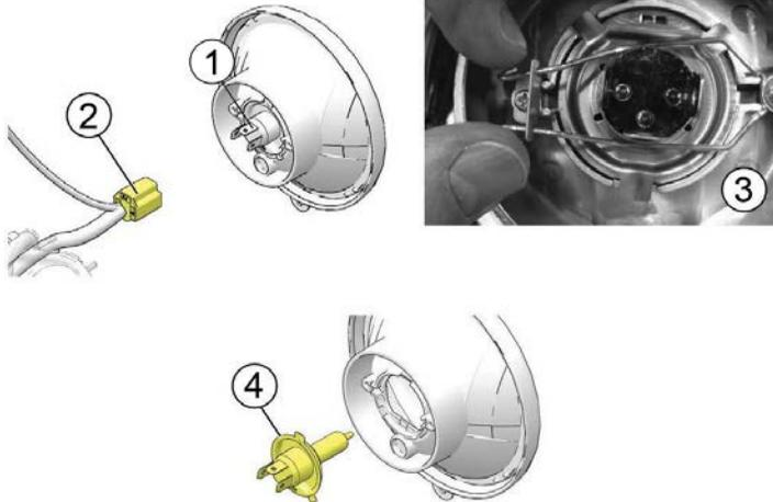
1. La lampadina del faro anteriore ① può essere raggiunta e rimossa dal retro del portalampada senza smontare il faro.
