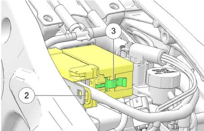
4. Dopo aver sostituito il fusibile, reinstallare il rivestimento della scatola fusibili.
