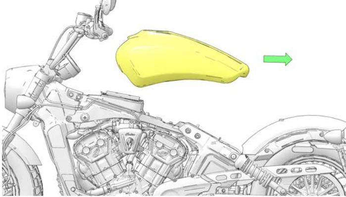
11. Sollevare il serbatoio del carburante dalla motocicletta e collocarlo su un'idonea superficie piana per evitare di danneggiarlo.
