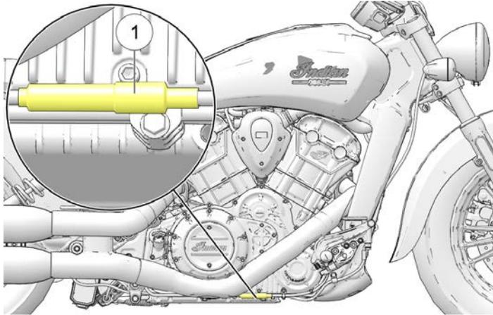
2. Tenendo fermo il cavo, girare il dispositivo di regolazione del cavo verso l'interno o verso l'esterno finché il gioco della leva della frizione non risulta di 0,5-1,5 mm ②.
