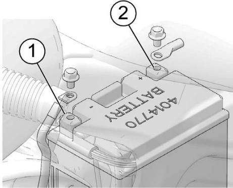
5. Rimuovere il rivestimento in gomma dal cavo positivo (+) della batteria e staccare il cavo ② dal terminale. Collocare il cavo ben lontano dal terminale.
