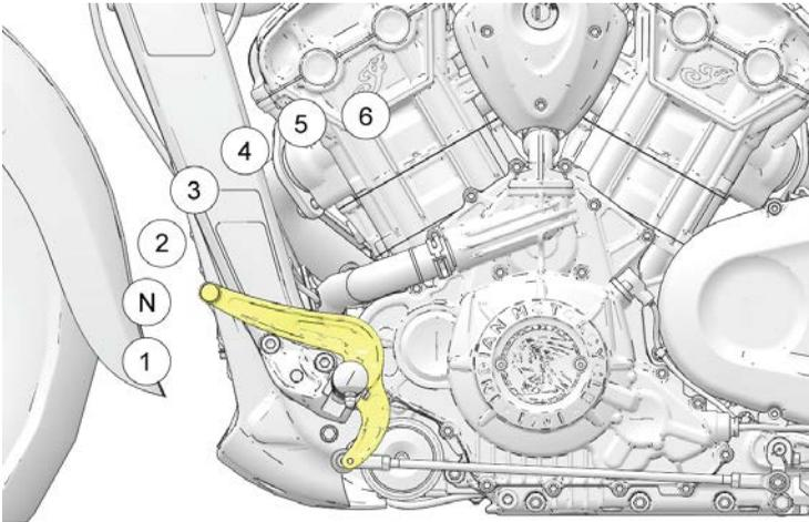
Premere la punta della leva per passare alla marcia inferiore. Sollevare la punta della leva per passare alla marcia superiore. Rilasciare la leva della frizione dopo ogni cambio marcia.
