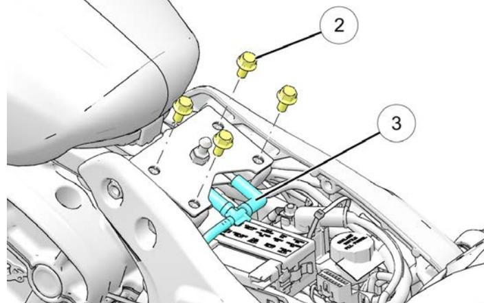
5. Scollegare la linea di sfiato del serbatoio del carburante e la linea di spurgo della cavità ③ sul retro del serbatoio del carburante.
