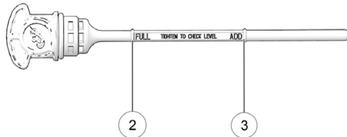
7. Reinstallare saldamente l'astina.
