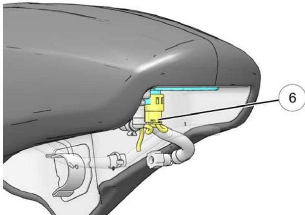
9. Far avanzare delicatamente l'estremità del gruppo di iniezione del carburante del tubo flessibile verso il centro del veicolo. Accertarsi che il tubo flessibile ed il connettore stiano lontani dal tubo flessibile del liquido di raffreddamento e da tutti i cablaggi.
