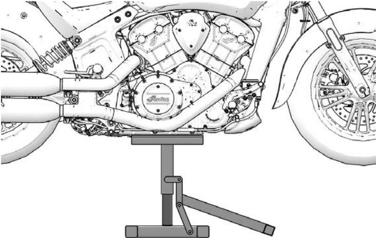
Collocare la piattaforma di sollevamento della motocicletta sotto il basamento del motore evitando il tappo di scarico dell'olio e sollevare la motocicletta in modo che la ruota anteriore non tocchi terra. Stabilizzare la motocicletta in posizione verticale con cinghie di ancoraggio o mezzo equivalente. La motocicletta DEVE essere stabile prima di eseguire le operazioni di manutenzione della cinghia.
