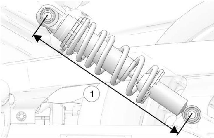
3. Misurare il precarico dell'ammortizzatore dal centro del bullone di montaggio superiore al centro del bullone di montaggio inferiore (da occhiello a occhiello) ①. Eseguire questa misurazione su entrambi gli ammortizzatori.
