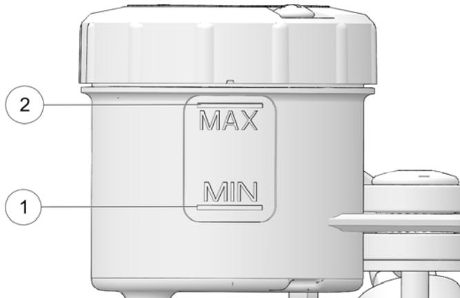
2. Osservare il livello del liquido del freno anteriore attraverso il serbatoio. Il liquido deve essere chiaro e il livello compreso tra i segni MIN ① e MAX ②.
