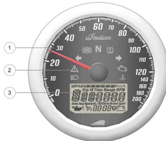
Il quadro della strumentazione comprende tachimetro, spie e display multifunzione (MFD).
